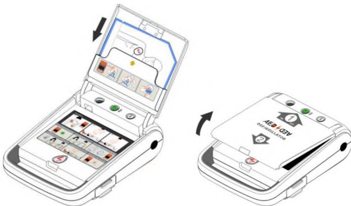
Рис. 16. Установка электрода взрослого в блок основной
