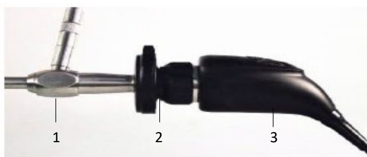
1 Лапароскоп 2 Оптический соединитель 3 Головка камеры с кабелем
