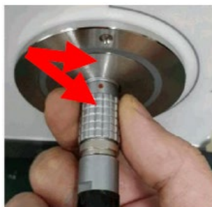
Рисунок 6 – Подсоединение головки камеры с кабелем к видеопроцессору
